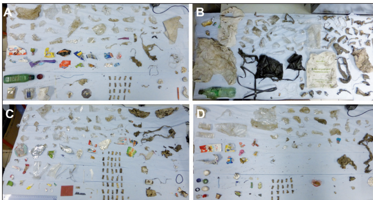
Figure 5. Objets trouvés fréquemment : dégrilleur S_{6cm} (A et B) et dégrilleur S_{1cm} (C et D)
